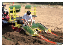
「トラクター直装ユニット」 長ねぎ移植 "Tractor-Mounted Unit" (PAPERPOT transplanter for green onions)
