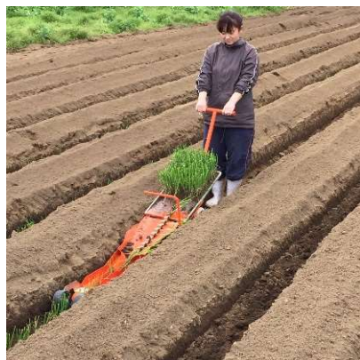
紙筒を連結した「チェーンポット®」 専用の移植機「ひっぱりくん®」
