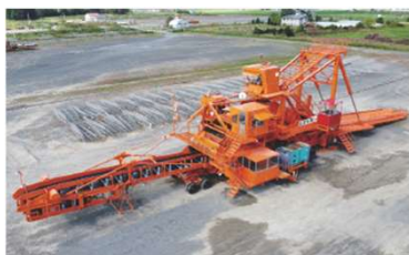
ビートパイラー ※全長約50m
